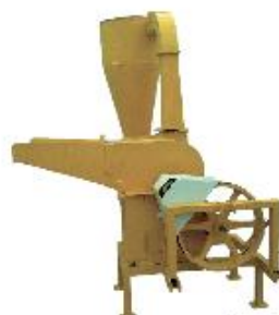
Molino remolque toma de fuerza y chasis con 3 puntos
